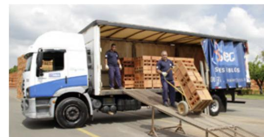
O caminhão sai da fábrica com o equipamento necessário para o descarregamento dos produtos na obra, na qual é possível montar rapidamente uma rampa metálica bem estruturada, por onde passam os carrinhos especiais que transportam os mini-paletes. A operação exige mínimo esforço por parte do operário.
